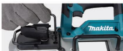
**Fácil ajuste de la vía de la cuchilla simplemente girando el tornillo**
